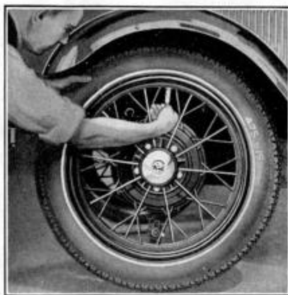
Figura 27 La línea roja sobre la cubierta del neumático debe quedar a una distancia uniforme alrededor de toda la llanta metálica
